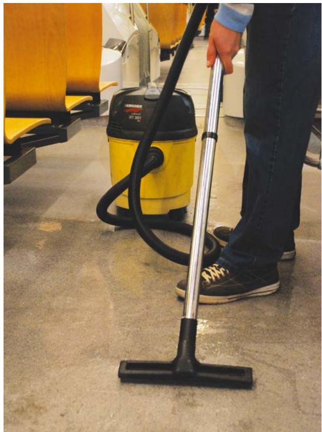
Odsátí špinavé vody
