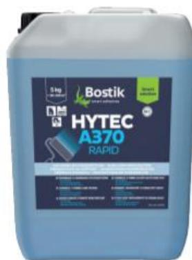
schnutí cca 60 minut. Druhá a třetí aplikace se pak provádí neředěným nátěrem s dobou schnutí 60 minut, vždy napříč ke směru aplikace předchozího nátěru. Žádná vrstva nátěru HYTEC A370 RAPID se nezasypává křemičitým pískem. Po úplném vyschnutí (po asi 12 hodinách) můžete zahájit stěrkování podkladu.
