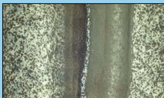
Fotografie z mikroskopu, na níž vidíme správně chráněný výrobek bez viditelných defektů
