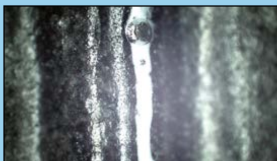
Fotografie z mikroskopu, na níž vidíme vizuální efekt použití standardní technologie s viditelnou „mléčnou“ skvrnou a vzduchovou bublinou
