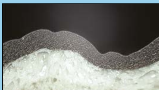
Fotografie z mikroskopu, na níž vidíme reálný produkt využívající novou technologii, celistvá ochranná vrstva bez viditelných defektů
